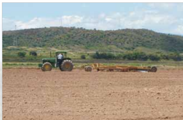
LAND PLANE, herramienta para mejorar el uso y manejo del suelo y agua
