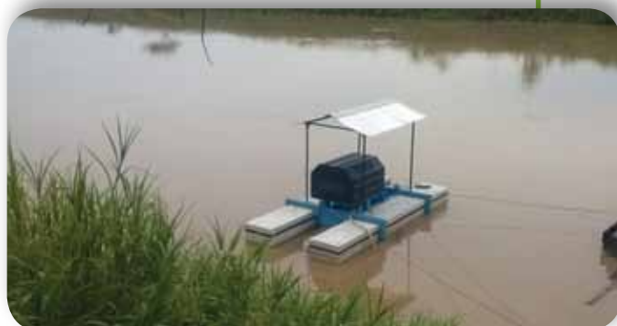
Bomba flotante eléctrica
