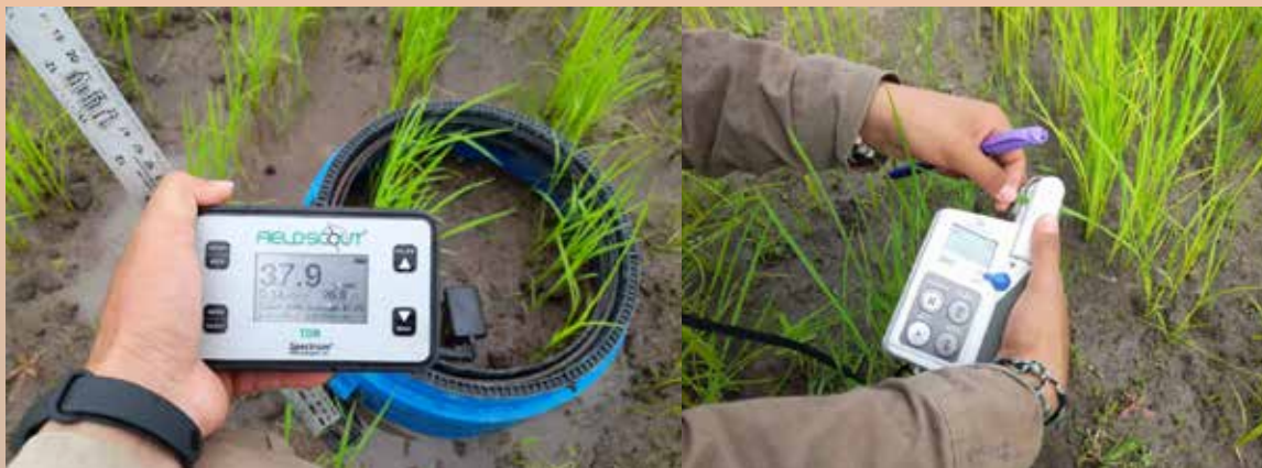
Figura 4. A. Evaluación de humedad del suelo con sensor portátil TDR al interior de una cámara, B. Evaluación del contenido de clorofila en las hojas de las variedades evaluadas.
