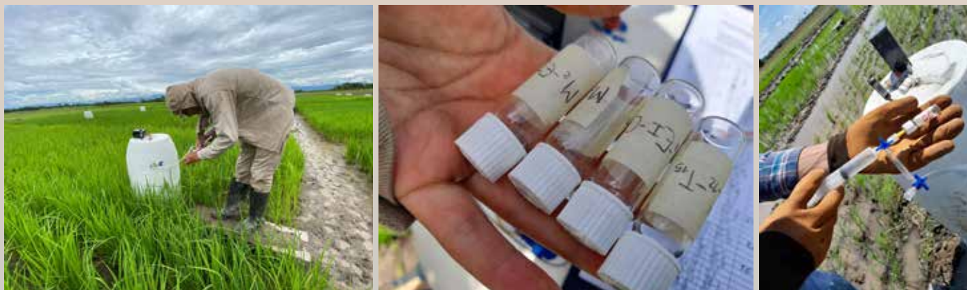
Figura 3. A. Extracción de la muestra de gas de la cámara, B. Viales al vacío para la conservación del gas, C. Inyección de la muestra de gas de la cámara hacia el vial.
