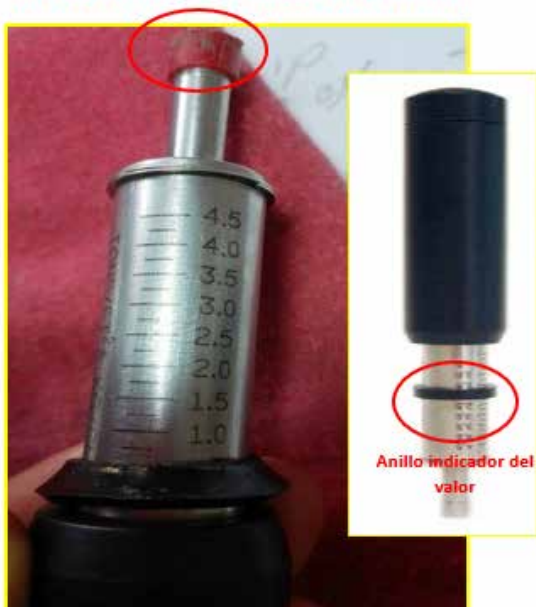
Figura 3. Calicata y Penetrómetro de bolsillo.
