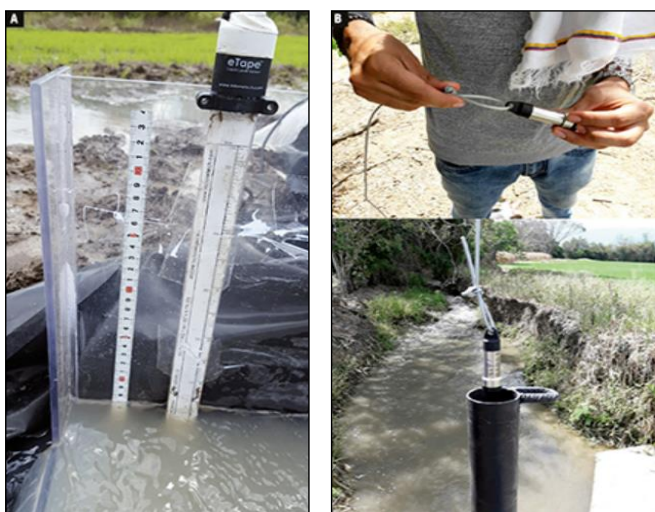
Figura 7. Dispositivos eTape (A) y Barodiver (B) para monitoreo de agua superficial en las entradas de agua de lotes y fincas arroceras dentro del programa AMTEC.
