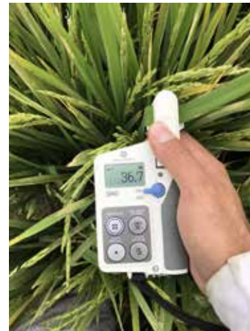
Figura 1. Medidor portátil de clorofila SPAD 502 cuantifican la salud de los cultivos.
